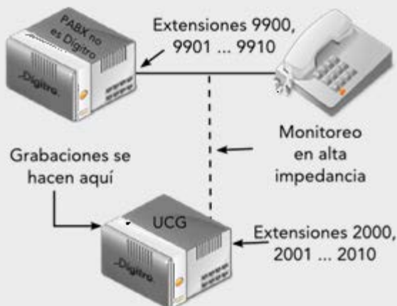
Figura 39. Ejemplo de PBX legado y monitoreo en alta impedancia
