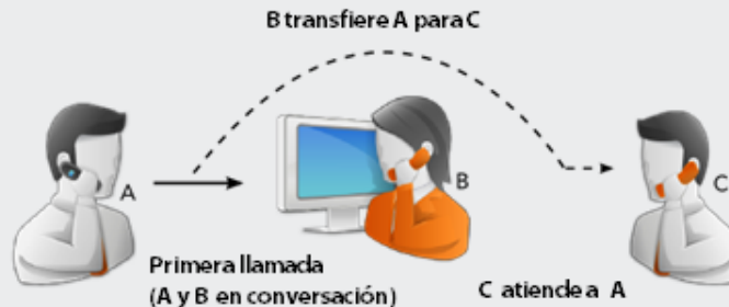
Figura 21. Transferencia inmediata de llamada
